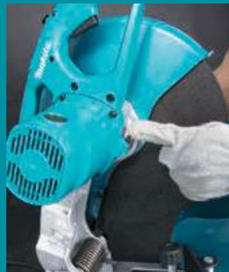
Bloqueio do eixo para uma fácil remoção do disco de corte.
