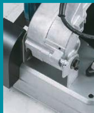
Substituição do dispositivo de bloqueio da cabeça da serra.
