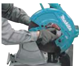
Substituição do disco abrasivo sem ferramentas adicionais
