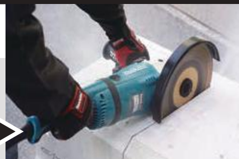
É possível girar o punho 90° para a esquerda e 90° para a direita.
