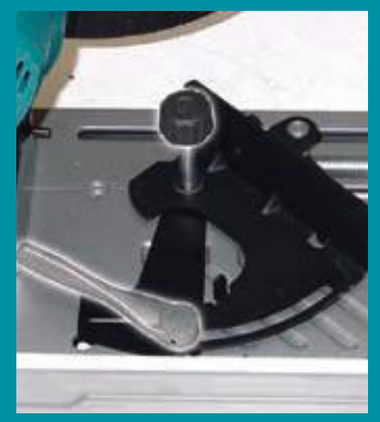
Ajuste rápido para a fixação da peça de trabalho.
